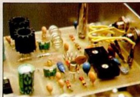
Detalle de los dos potenciómetros de ajuste de profundidad de modulación y nivel de sonido.
