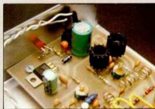
Detalle de los disipadores en los transistores del oscilador de VHF. Los condensadores de ajuste y las bobinas en primer plano.
